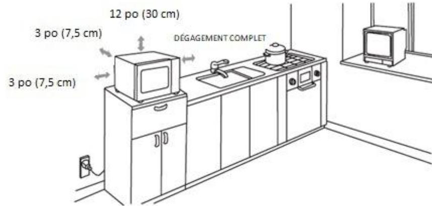
Un dégagement minimal de 3 po (7,5 cm) est nécessaire entre le four et tout mur adjacent. L'un des côtés doit être complètement dégagé.
