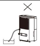
如果您不想經常去倒水箱裡的水,可以在本機後面連接一個排水管(管的內徑為9.0毫米)排水, (用戶需自行購買排水管)。
