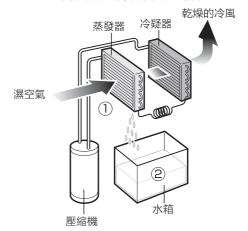
常溫空氣經過蒸發器後,水蒸氣遇冷液化,在蒸發器表面形成水滴。
