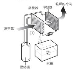
常溫空氣經過蒸發器後,水蒸氣遇冷液化,在蒸發器表面形成水滴。
