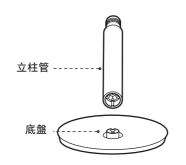
將螺栓插入底盤底部的孔位, 擰緊螺栓 固定立柱與底盤。
