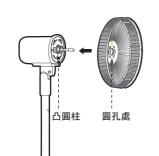
在電機頭部掛上後網罩後,順時針方向 旋轉網罩索母,鎖定後網罩。
