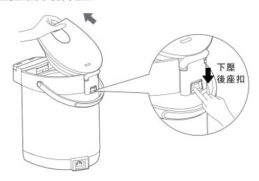
**2** 安裝瓶蓋: 一只手下壓後座扣,另一只手將瓶蓋與連接軸對準,放置於卡槽中,然後松開後座扣即可固定瓶蓋,完成瓶蓋安裝
