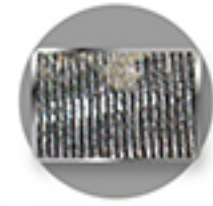
แผงคอยล์ที่ไม่ถูกเคลือบ ด้วยสาร Aqua Resin
