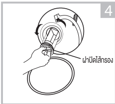
เปิดฝาปิดตัวกรองด้วยการหมุน ทวนเข็มนาฬิกา
