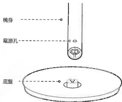
將螺栓插入底盤底部的孔位元，擰緊螺栓固定機身與底盤。
