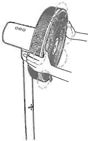
再將前網罩底部網扣卡穩，將網罩
