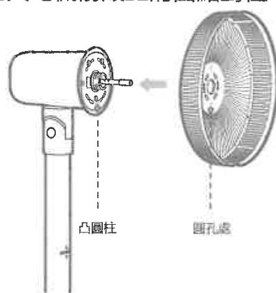
在電機頭部掛上後網罩後，順時針方向旋轉網罩索母，鎖定後網罩。
