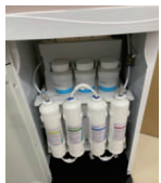
23. Gắn ống nhựa PE trên máy vào lại. Gắn đầu nối nhanh vào bộ lọc Nano Silver-T33.
