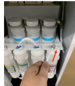
20. Gắn thêm 1 đoạn ống nhựa PE vào ngõ ra của bộ lọc Nano Silver-T33 để nước chảy ra ngoài.
