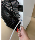
18. Tháo ống nhựa PE từ ngõ vào nước máy.
