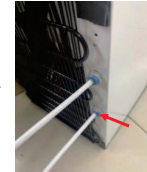
25. Gắn vòng chốt khóa vào khe hở để khóa chặt vòng khóa. Sau đó, mở van cấp nước vào và cắm phích điện nguồn, rồi sử dụng bình thường.
