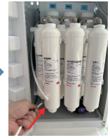
20. Gắn ống nhựa PE ở bước 19 vào đầu vào của bộ lọc Tourmaline.
