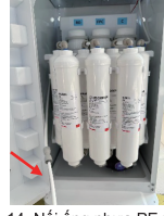
14. Nối ống nhựa PE và mở nguồn nước và điện. Hãy để nước chảy ra liên tục khoảng 10 phút.
