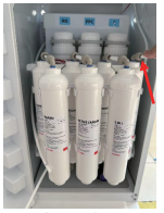
21. Nối một ống nhựa PE khác vào đầu ra của bộ lọc nano bạc-T33.
