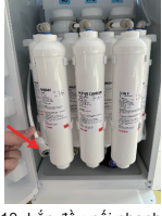
13. Lắp đầu nối nhanh vào ống nhựa PE.
