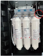
16. Rút ống nhựa PE ra khỏi đầu ra của đầu ra của bộ lọc nano bạc-T33.
