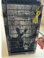
18. Tháo ống nhựa PE ra khỏi ngò vào nước máy.
