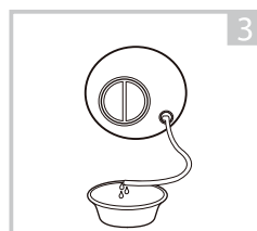
Sau khi đã xả hết nước ra ngoài, hãy đóng nắp rồi cài lại ống vào móc giữ
