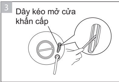
3. Dùng dụng cụ không sắc bén cắm vào vòng dây kéo và kéo xuống để mở khóa cửa máy giặt.
