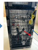
24. Gắn vòng khóa vào khe hở của ngõ vào nước máy. Sau khi lắp đặt, mở khóa nước và cấp điện, và sử dụng bình thường.
