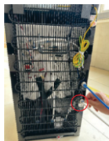
16. Tháo vòng khóa ra khỏi nút ngõ vào nước máy.
