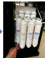
18. Gắn ống nhựa PE ở bước 17 vào đầu vào của bộ lọc Tourmaline.
