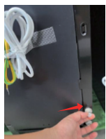
6. Tháo chốt ở ngõ vào nước máy và ngõ ra nước xả.
