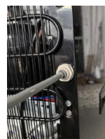
9. Lắp ống PE vào ống thoát khí (Cảnh báo: Tránh bong)
