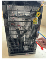
19. Rút ống PE ra khỏi van cấp nước.
