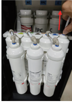
12. Rút ống nhựa PE ra khỏi đầu ra của bộ lọc nano bạc-T33.
