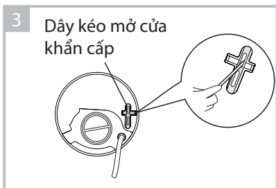
3. Dùng dụng cụ không sắc bén cắm vào vòng dây kéo và kéo xuống để mở cửa máy giặt.
