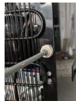
9. Lắp ống nhựa PE vào ngò xả khí (Cảnh báo: Tránh bị bỏng)
