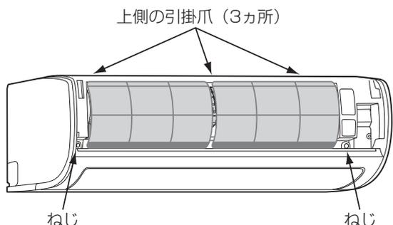
3. 本体パネルの両側面を手前に引きながら、右手の親指で電気部品箱を押ししてください。
