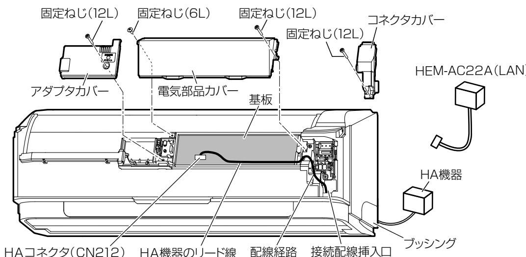
4. 電気部品カバーを取り付け、ねじ固定する。
