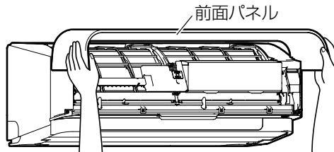
2. アダプタカバー (固定ねじ1本) をはずし電気部品カバー (固定ねじ2本) ならびにコネクタカバー (固定ねじ1本) をはずす。
