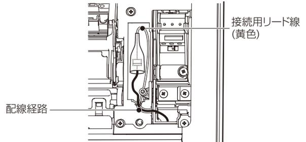
4. コネクタカバーを取り付け、ねじで固定します。
