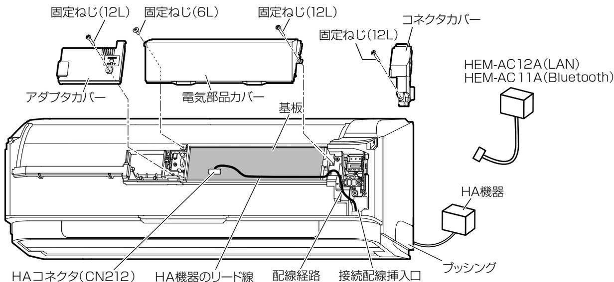
4. 電気部品カバーを取り付け、ねじ固定する。
