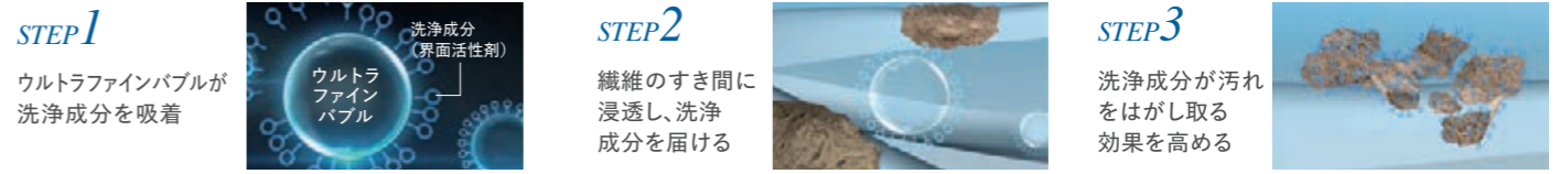
STEP1 ウルトラファインバブルが洗浄成分を吸着 STEP2 繊維のすき間に浸透し、洗浄成分を届ける STEP3 洗浄成分が汚れをはがし取る効果を高める 画像はすべてイメージです。
