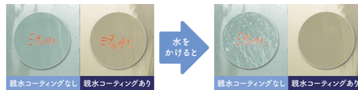
親水コーティングがない場合とある場合の汚れ落ちの比較
