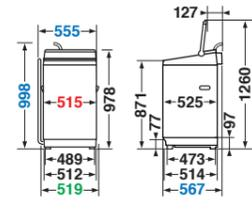
●奥行(内寸)が540mmより大きな防水パンに設置できます。●防水パンに設置する場合は、本体後方の壁面から防水パン前部の内側まで600mm以上必要です。●右側に排水する場合、左側に排水する場合より、本体から出る排水ホースの長さが短くなります。排水口に届かない場合は、別売の排水延長ホースをご使用ください。
