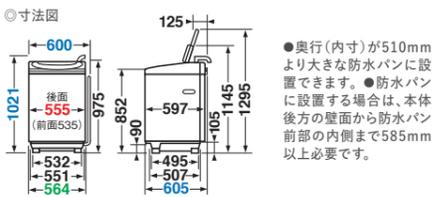
●奥行(内寸)が510mmより大きな防水パンに設置できます。●防水パンに設置する場合は、本体後方の壁面から防水パン前部の内側まで585mm以上必要です。
