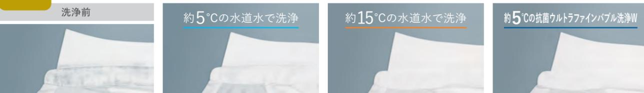
●AW-10VP2、ウルトラファインバブル水と水道水の標準コースで5kg洗濯時の比較。●衣類の量・汚れ・洗剤の種類などによって効果は異なります。(当社調べ)
