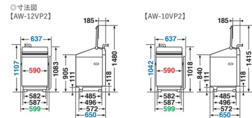
●奥行(内寸)が550mmより大きな防水パンに設置できます。●防水パンに設置する場合は、本体後方の壁面から防水パン前部の内側まで590mm以上必要です。●左側に排水する場合、右側に排水する場合より、本体から出る排水ホースの長さが短くなります。排水口に届かない場合は、別売の排水延長ホースをご使用ください。
