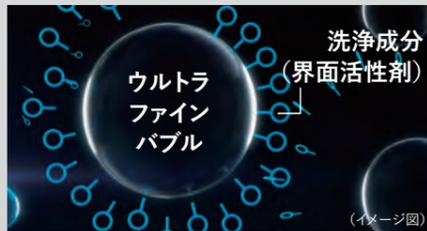
ウルトラファインバブルが洗剤の洗浄成分を吸着
