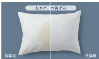
●衣類の量・汚れ・洗剤の種類などによって効果は異なります。日光などで変色した汚れ・黄ばみは落ちません。●この写真の黄ばみは、皮脂汚れによるものです。●写真は「約40°Cつけおき(洗濯)」設定時(つけおき時間約360分)粉末合成洗剤を通常の約2倍使用、洗濯容量3kg運転の場合の洗浄実験結果です。(当社調べ)
