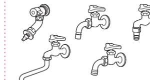
給水ホースを直接差し込める水栓(洗濯機用水栓)の場合、水栓メーカーによる洗濯機用水栓の場合でも適合しないものがあります。一般社団法人日本電機工業会規格JEM1206に準拠した水栓をご使用ください。
