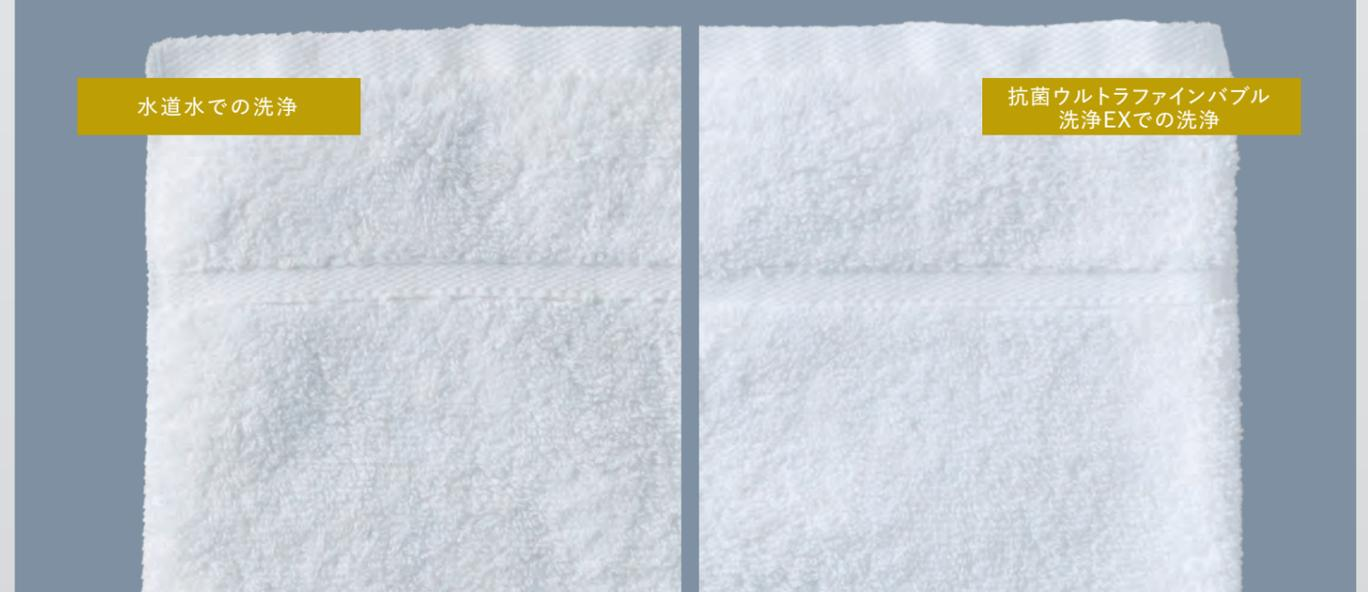
●疑似汚れを付着させた6kgの衣類を水道水での洗浄と抗菌ウルトラファインバブル洗浄EXで標準コースで5サイクル洗濯後の比較。●衣類の量・汚れ・洗剤の種類などによって効果は異なります。(当社調べ)
