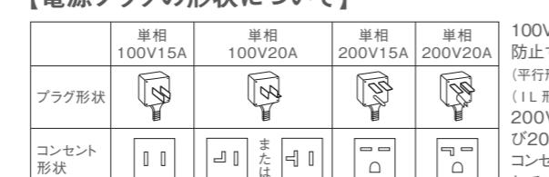
100Vと200Vの誤接続を防止するため、100V15A(平行形)および100V20A(L形)のコンセント、200V15A(タンドム)および200V20A(エルバ)-のコンセント形状が規格化されています。
