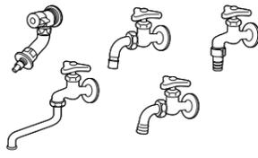
給水ホースを直接差し込める水栓(洗濯機用水栓)の場合、水栓メーカーによる洗濯機用水栓の場合でも適合しないものがあります。一般社団法人日本電機工業会規格JEM1206に準拠した水栓をご使用ください。
