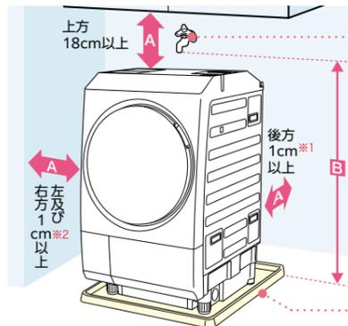
※1TW-84GS4の後方は給水ホース設置距離として4cm以上必要となります。※2排水ホースが通る側は10cm以上。
