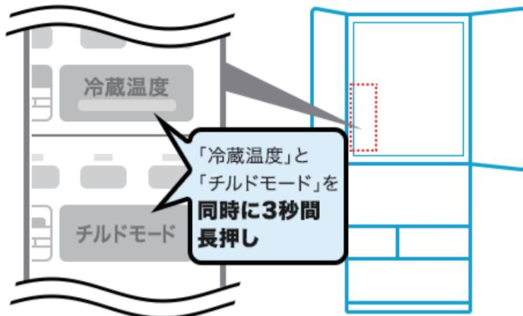
1. 「冷藏温度」ボタンと「チルドモード」ボタンを同時に3秒間長押しする
