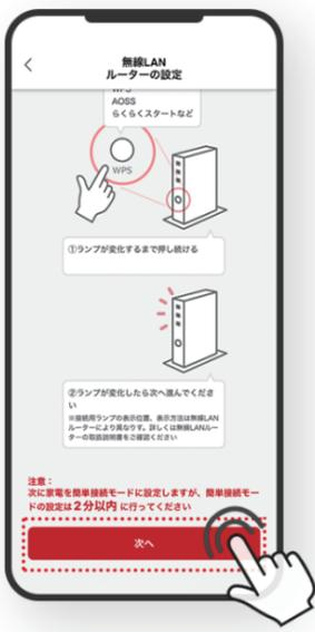
3.無線LANルーターにある「WPS」「らくらくスタート」「AOSS」などのボタンを接続用ランプが変化するまで長押しして接続できる状態になったら、アプリ画面の「次へ」をタップ
