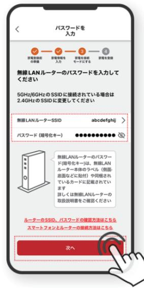
3.無線LANルーターの「SSID」「パスワード(暗号化キー)」を入力し「次へ」をタップ
