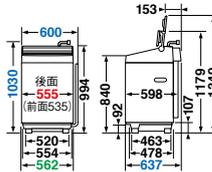
●奥行(内寸)が510mmより大きな防水パンに設置できます。●防水パンに設置する場合は、本体後方の壁面から防水パン前部の内側まで590mm以上必要です。
