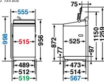
●奥行(内寸)が540mmより大きな防水パンに設置できます。●防水パンに設置する場合は、本体後方の壁面から防水パン前部の内側まで600mm以上必要です。●右側に排水する場合、左側に排水する場合より、本体から出る排水ホースの長さが短くなります。排水口に届かない場合は、別売の排水延長ホースをご使用ください。
