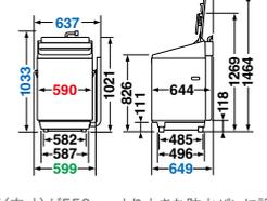
●奥行(内寸)が550mmより大きな防水パンに設置できます。●防水パンに設置する場合は、本体後方の壁面から防水パン前部の内側まで590mm以上必要です。●左側に排水する場合、右側に排水する場合より、本体から出る排水ホースの長さが短くなります。排水口に届かない場合は、別売の排水延長ホースをご使用ください。
