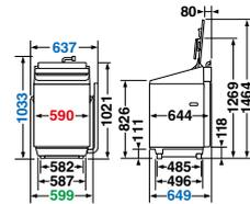
●奥行(内寸)が550mmより大きな防水パンに設置できます。●防水パンに設置する場合は、本体後方の壁面から防水パン前部の内側まで590mm以上必要です。●左側に排水する場合、右側に排水する場合より、本体から出る排水ホースの長さが短くなります。排水口に届かない場合は、別売の排水延長ホースをご使用ください。
