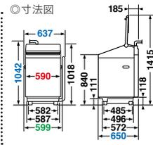
●奥行(内寸)が550mmより大きな防水パンに設置できます。●防水パンに設置する場合は、本体後方の壁面から防水パン前部の内側まで590mm以上必要です。●左側に排水する場合、右側に排水する場合より、本体から出る排水ホースの長さが短くなります。排水口に届かない場合は、別売の排水延長ホースをご使用ください。
