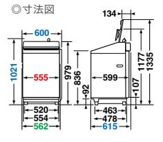
●奥行(内寸)が510mmより大きな防水パンに設置できます。●防水パンに設置する場合は、本体後方の壁面から防水パン前部の内側まで570mm以上必要です。
