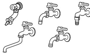
給水ホースを直接差し込める水栓(洗濯機用水栓)の場合、水栓メーカーによる洗濯機用水栓の場合でも適合しないものがあります。一般社団法人日本電機工業会規格JEM1206に準拠した水栓をご使用ください。
